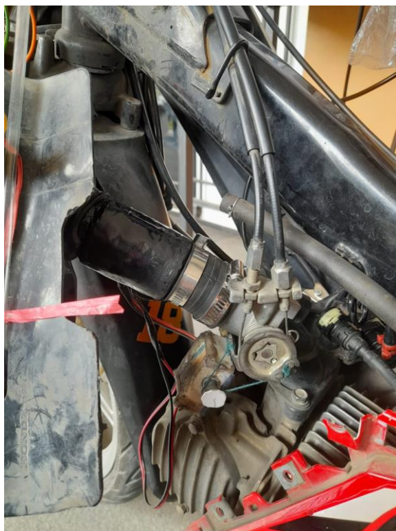
Gambar 9. Pemasangan turbo elektrik pada sepeda motor
